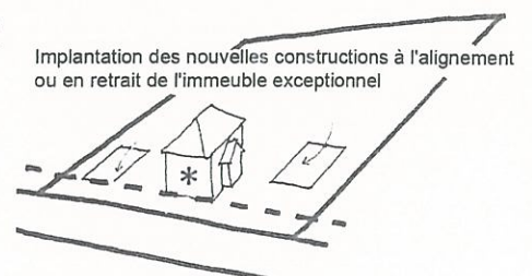
Fig 1 : Les nouvelles constructions situées sur l'unité foncière d'un bâtiment exceptionnel ou à préserver se situeront à l'alignement ou à l'arrière de ce bâti, par rapport à la façade antérieure* de l'immeuble
